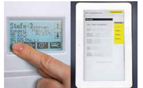
profi-air havalandırma ünitesinde dokunmatik ekran / muhtemel tablet bilgisayar kumandası
